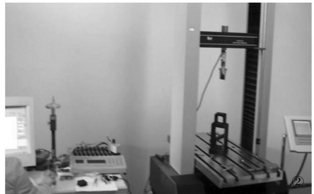
图 1 单钉-沟槽柱翼钢板和 WDFC ①钢板;②尾柱;③尾翼;④椎弓根钉;⑤椎弓根螺母;⑥WDFC 图 2 WDW-3000 型电子万能试验机
